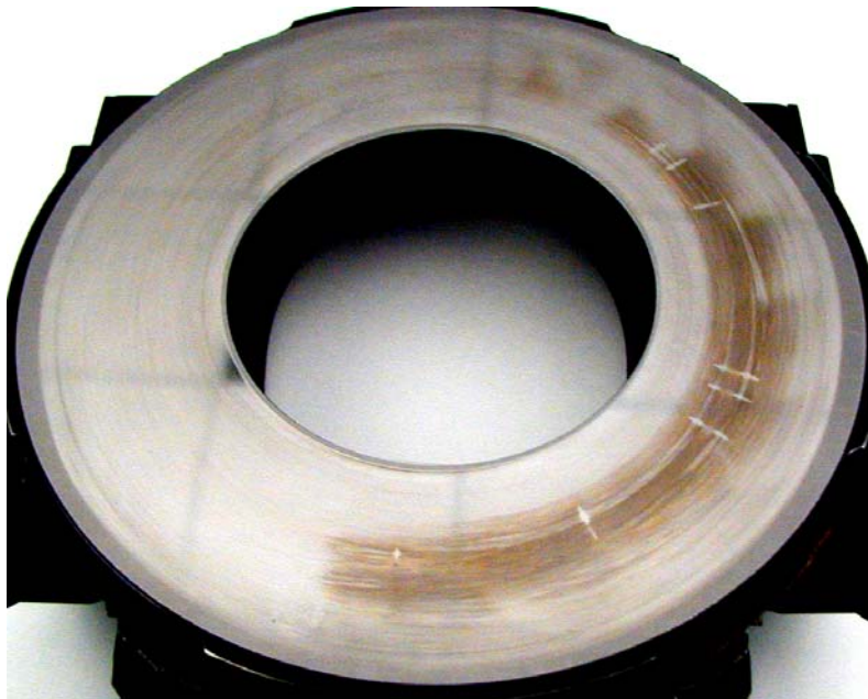
Рис. 2. Рабочая поверхность опорного диска серийного аксиально-плунжерного гидронасоса со следами переноса части материала гидростатических опор, и температурного разрушения.
