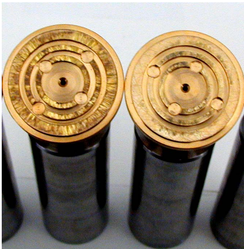
Рис. 1. Рабочие поверхности гидростатических опор серийно-выпускаемой гидромашин со следами износа и температурных разрушений.
